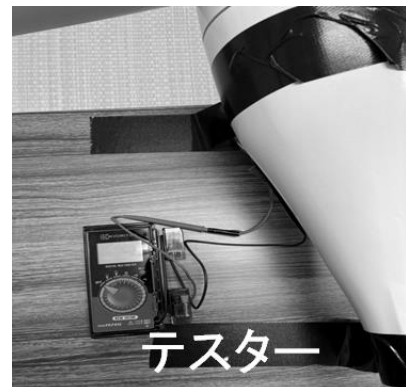
図 7 小型風力発電機に接続したテスター
