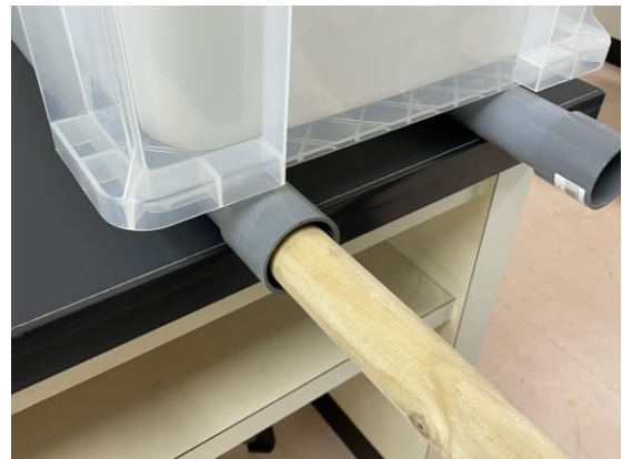
図13 塩ビパイプ内に木材を入れ補強
