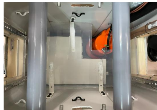
図7 発泡スチロールを用いたシャッター機構
