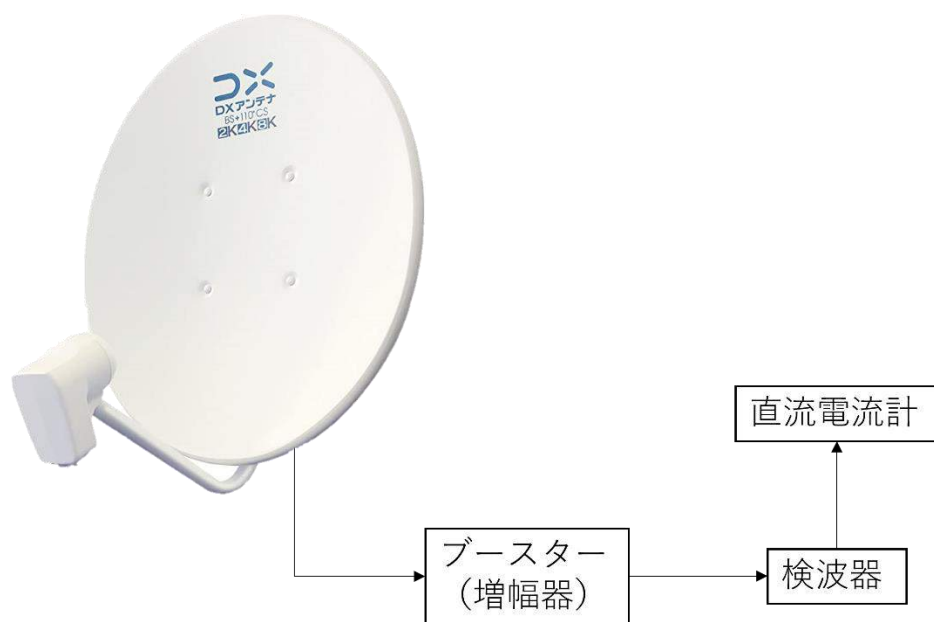
図 3-1. 電波望遠鏡の仕組みの概略
