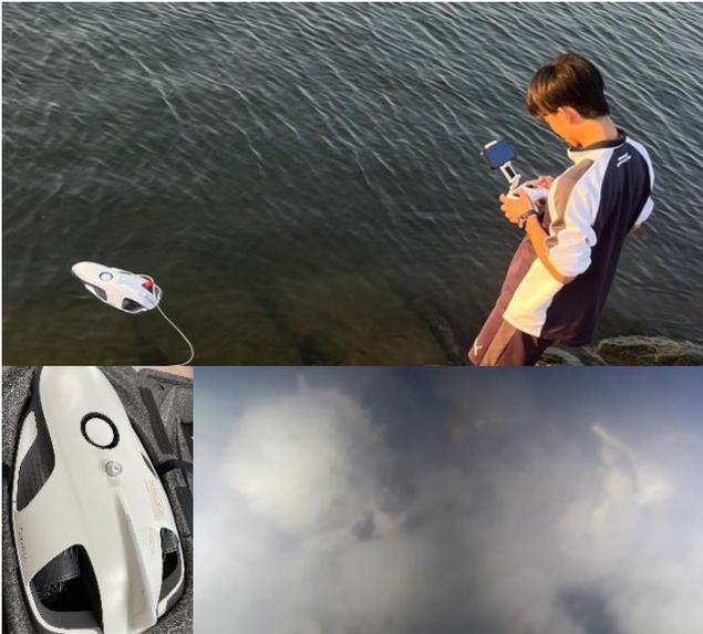
図10 水中ドローンを用いた冠水時のウミナ観察
