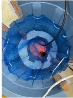
図2 装置内ゴミ回収網
